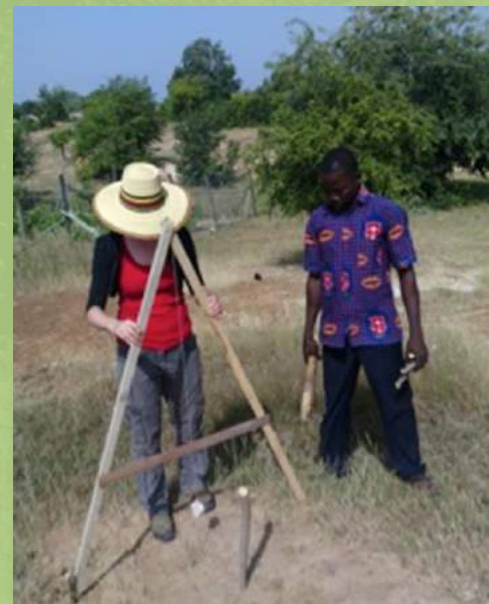
Carolien is samen met een docent een hoogtelijn aan het uitzetten
